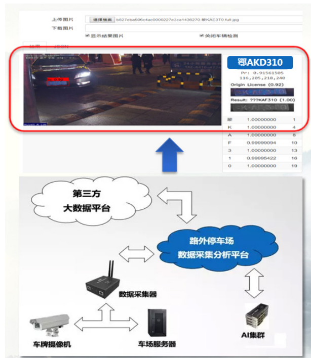
智能数据探针自动采集架构示意图
